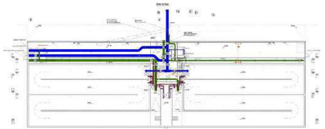
Neue Trinkwasseraufbereitungsanlage des SEBES mit Pumpwerk, Druckleitungen und Verteilerleitung
