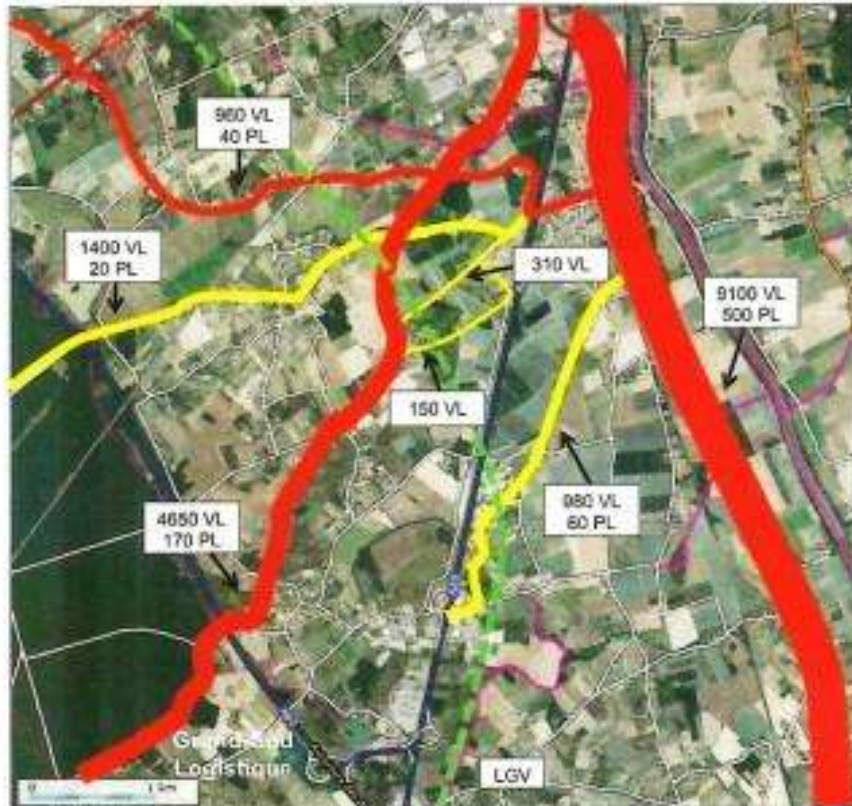
Flux de circulation des véhicules légers et de poids-lourds sur les principales voies de circulation coupées par la LGV.
