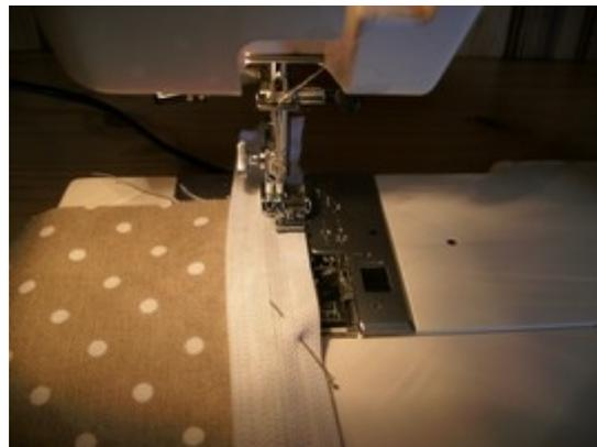
Maintenant nous allons mettre en place la grande bande de tissu intérieur sur le ruban de la fermeture éclair, endroit contre endroit ; je préconise de bâtir cette pièce une fois qu'elle est épinglée (fig, 5 )car nous allons la coudre en même temps que nous ferons la surpiqûre du tissu extérieur, En suivant bien la façon de poser les tissus sous le pied de biche de la fig, 6
