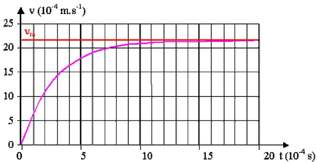
حركة مركبة الكثافة تم عبر نظامين : نظام بدئي تتغير خلاله السرعة ونظام دائم تأخذ فيه السرعة قيمة ثابتة تساوي السرعة الحدية  $v_m = 21,5 \cdot 10^{-4} \text{ m.s}^{-1}$  (انظر الجدول )
