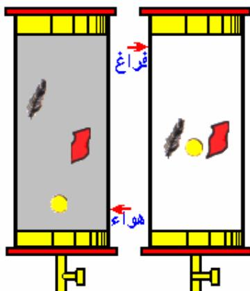
السقوط الحر لجسم صلب هو حركة مركز قصورة G في مرجع أرضي، عندما يخضع هذا الجسم لقوة الثقالة فقط. تكون حركة السقوط الحر رأسية إذا كان مسار G مستقيماً وتحقق عند انطلاق الجسم بدون سرعة بدئية أو عند إرساله بسرعة بدئية رأسية.
